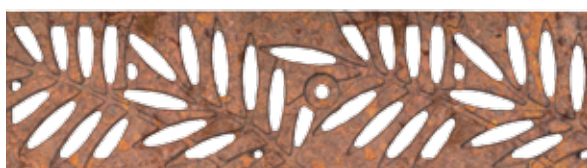
Designgaller, LEAF, gjutjärn, obehandlad Belastningsklasser: C250, Längd: 50 cm, SW 5 - 9 mm
