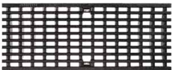
Längsgående Galler , gjutjärn, pulverlackat Belastningsklasser: D400*, E600*, Längd: 50 cm, MW 25 x 11 mm
