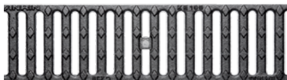
Slitsat galler SW 10 , gjutjärn, målat i svart Belastningsklasser: C250, Längd: 50 cm, SW 10 mm
